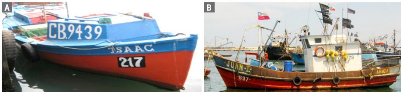
**Figura 10.** A) Lancha espinelera menor a 12 metros de eslora; B) Lancha espinelera mayor a 12 metros de eslora.
